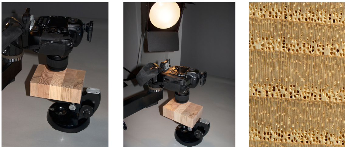
Abbildung 6.1: Aufbau der Fotografeumgebung sowie ein aufgenommener Querschnitt
