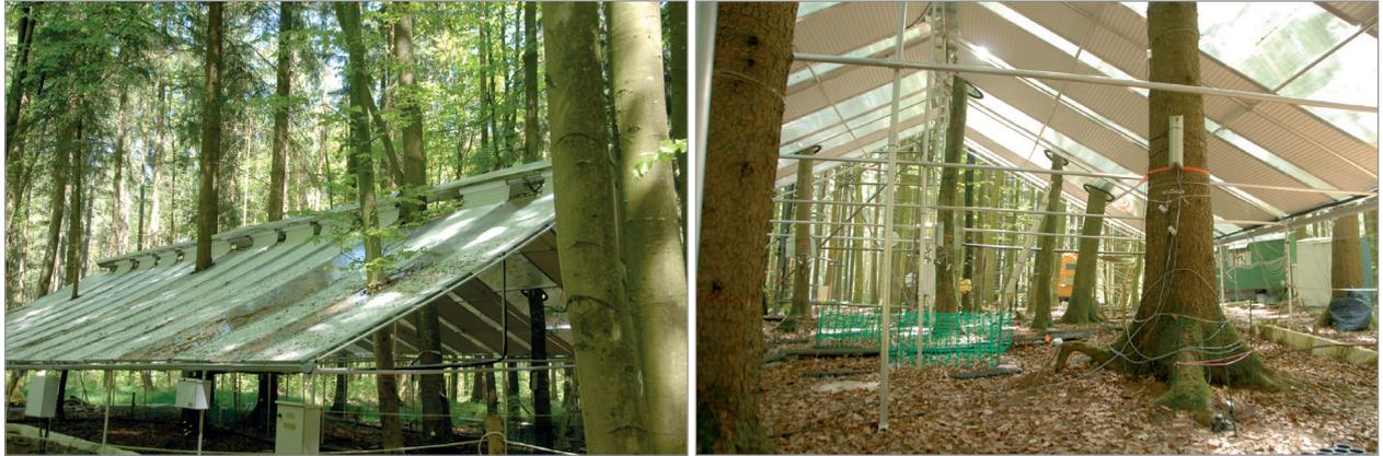
Abbildung 8: Ein Teil der Fichten-Buchen-Mischbestandsversuchsfläche 813 im Kranzberger Forst wird als interdisziplinärer Austrocknungsversuch weitergeführt. Bei Regen automatisch schließende Dächer halten von Rein- und Mischbeständen den Niederschlag ab, so dass analysiert werden kann, wie Fichte und Buche in Mischung im Vergleich zum Reinbestand auf Trockenheit reagieren
